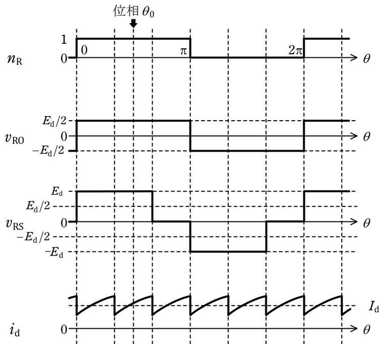
(3) 二つの電圧波形 $v_{R0}$ 、 $v_{RS}$ のうち、出力周波数に対して $3n$ 次高調波が含まれている波形は $180^\circ$ 通電モードである $v_{R0}$ である。 $v_{RS}$ は三相線間電圧であるので、 $3n$ 次高調波が打ち消されて含まれない。
